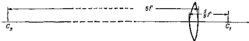
图 5.10 无彗差薄透镜(物在无穷远)
