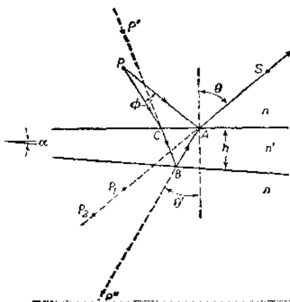
点光源的波阵面经平面反射和折射后的曲率中心.
