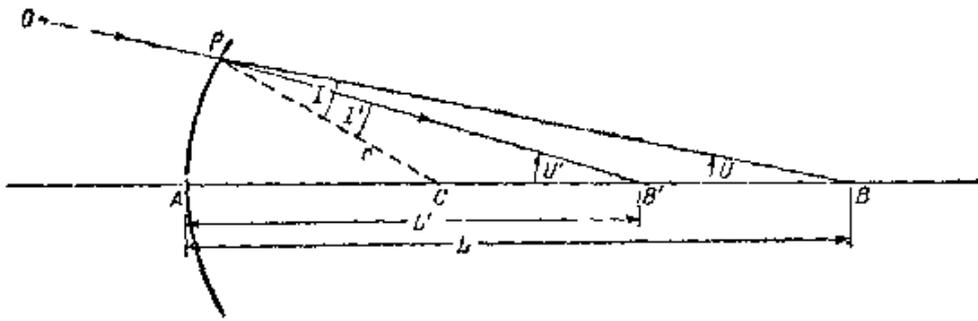
图 4.37 斜子午光线追迹所用的表示法
