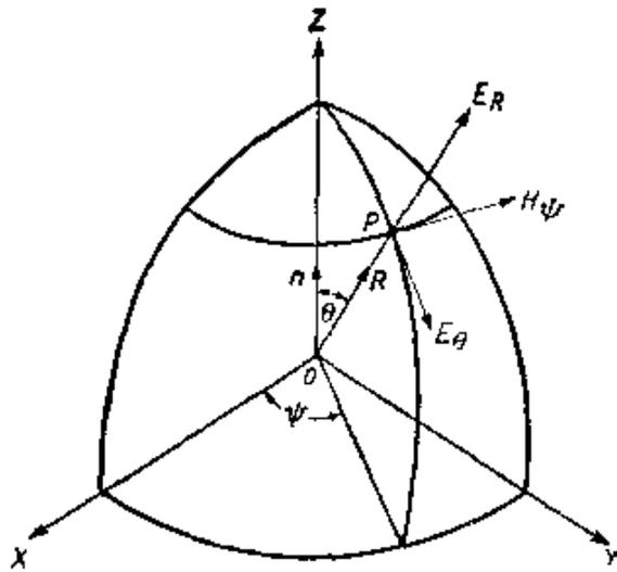
图 2.2 线性电偶极子的场的计算, 偶极子矩矢量沿  $z$  轴
