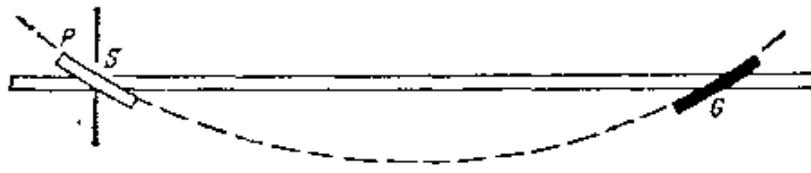
图 8.29 凹面光栅的伊格尔装置
