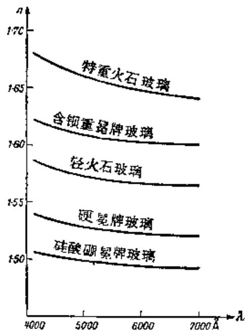
图 4.24 各种玻璃的典型色散曲线
