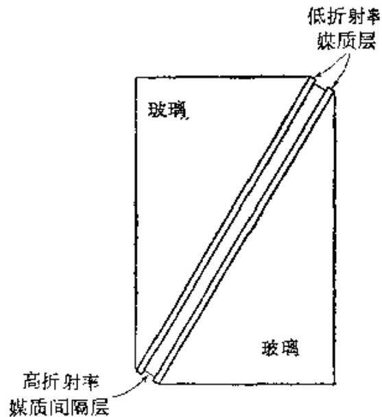
图 7.72 受抑全反射干涉滤波器
