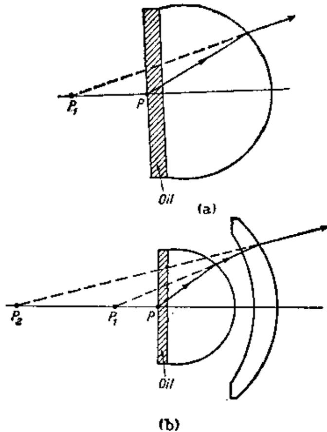
图 6.28 显微镜中, 光线角发散度的减小
