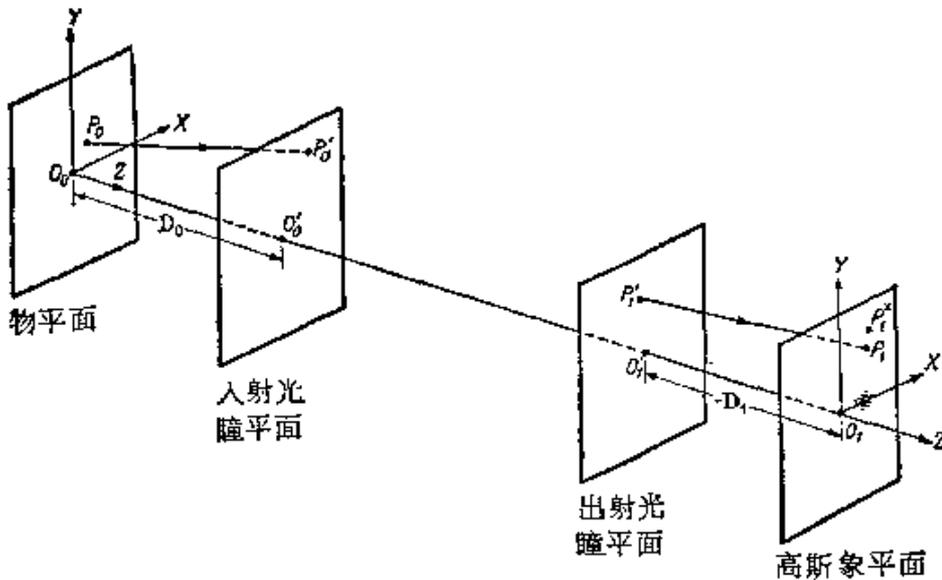
图 5.1 物平面、象平面和光瞳平面
