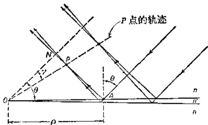
图 7.37 当光源在无穷远时劈条纹的定域
