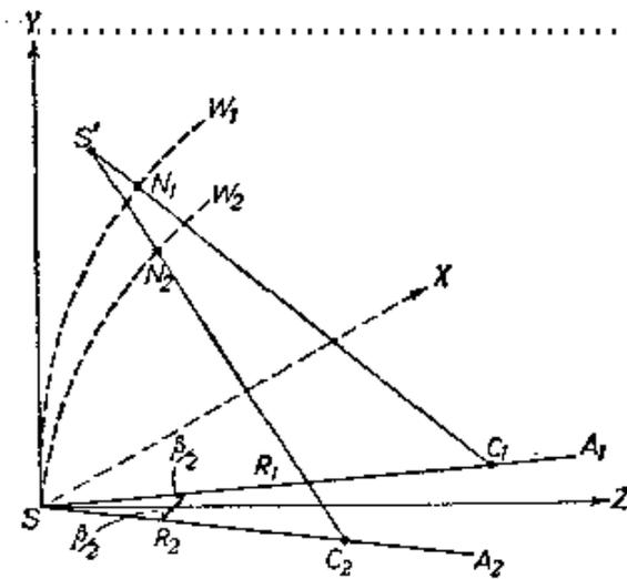
图 7.34 双光束干涉装置条纹定域讨论图示
