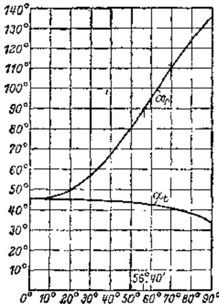
图 1.14 方位角随入射角的变化关系
