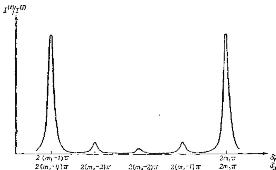
图 7.81 两块平行平面板产生的多光束等倾条纹: 透射强度与人射强度之比随位相差  $\delta_1$  和  $\delta_2$  的变化曲线
