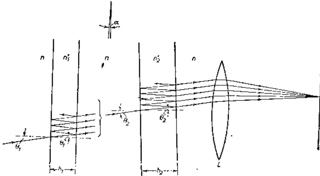
图 7.80 入射光在两块平行平面板内多次反射后于无穷远处产生条纹图示
