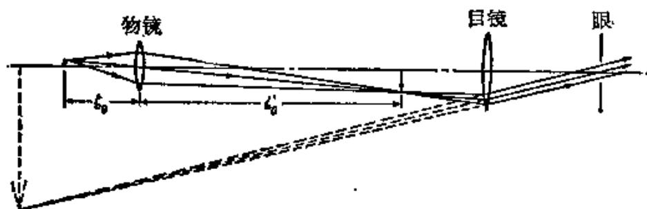
图 6.27 显微镜原理的图示
