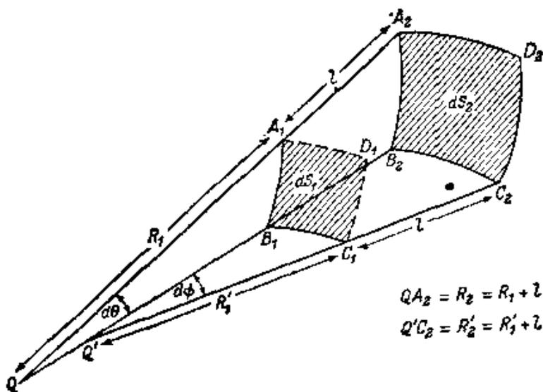
图 3.3 直线光线情况下几何光学的强度定律图示
