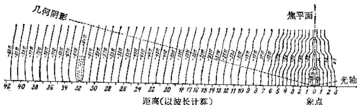
图 8.45 几何焦点附近等相面 $\phi(u, v) = \text{常数}$ 的断面图,计算数据:
