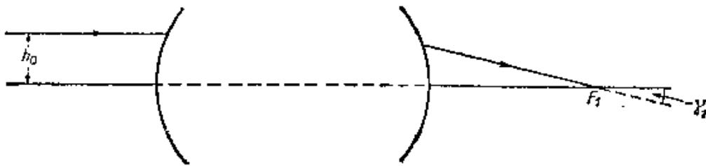
图 4.19 物在无穷远时的正弦条件
