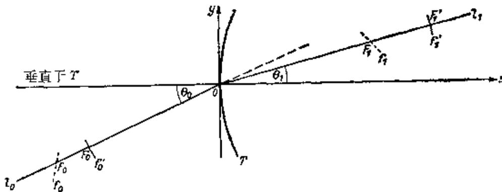
图 4.22 一个细象散光锥的折射
