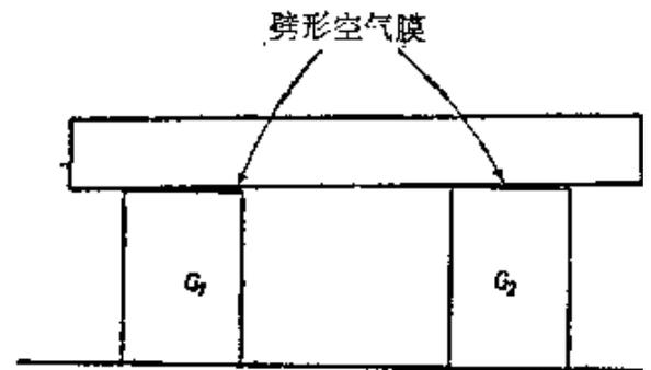
图 7.27 端规的干涉量度比较
