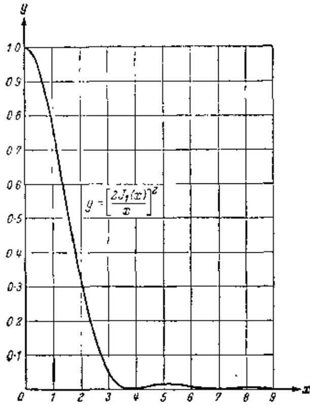
图 8.11 圆孔夫琅和费衍射，函数  $y = \left(\frac{2J_1(x)}{x}\right)^2$
