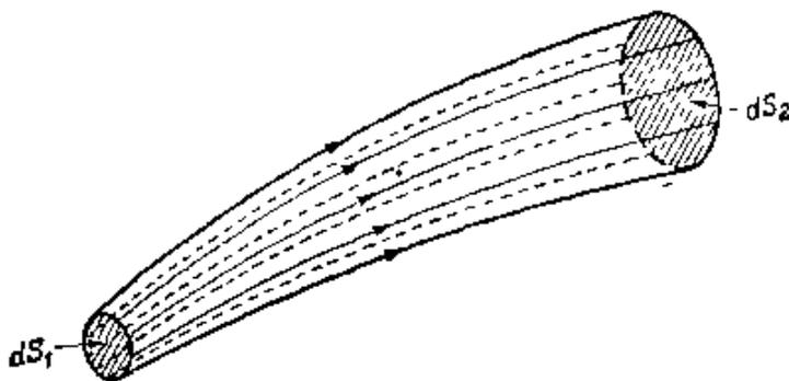
图 3.2 几何光学的强度定律图示
