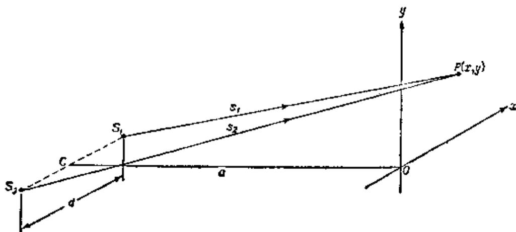
图 7.3 两个点光源产生干涉的几何图示
