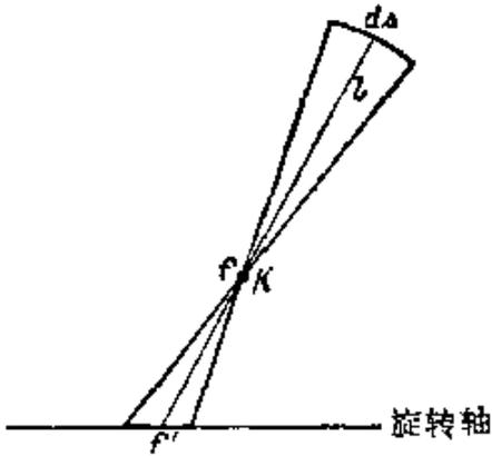
图 4.21 圆柱对称波阵面的焦线
