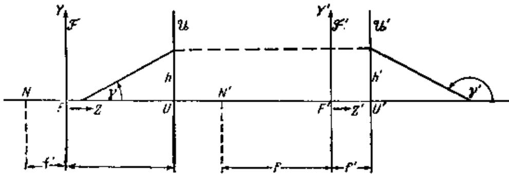
图 4.10 一个光学系统的基点和基面
