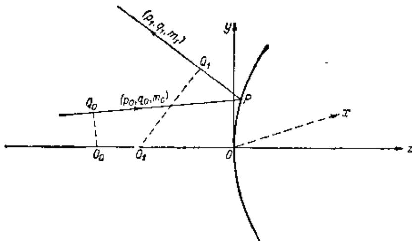
图 4.5 旋转反射面的角特征函数.
