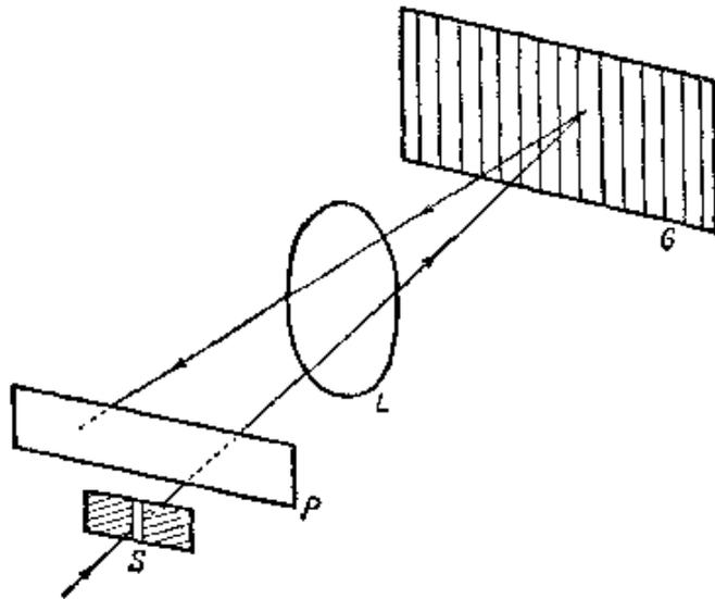
图 8.25 光栅摄谱仪：利托装置
