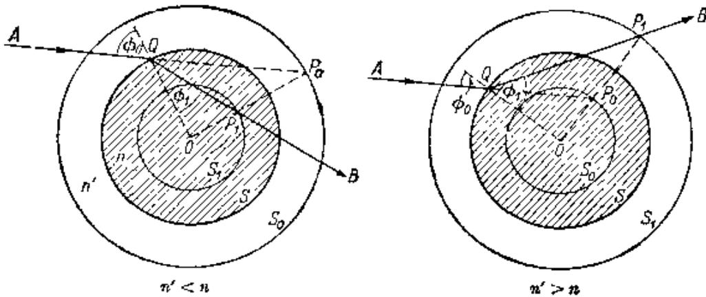
图 4.9 在一个球面上的折射，不晕点
