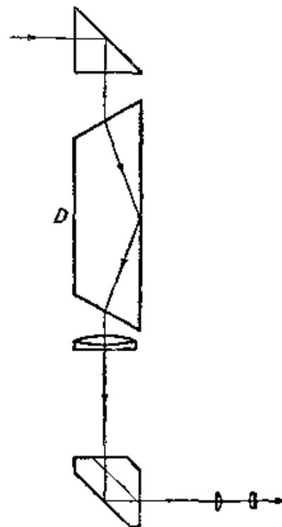
图 6.16 具有 Dove 棱镜的潜望镜
