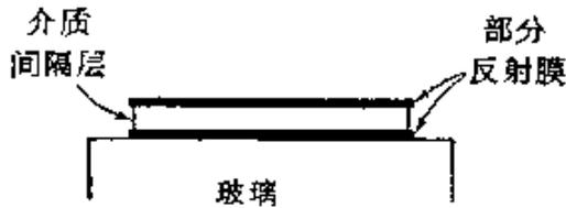
图 7.71 法布里-珀罗型干涉滤波器
