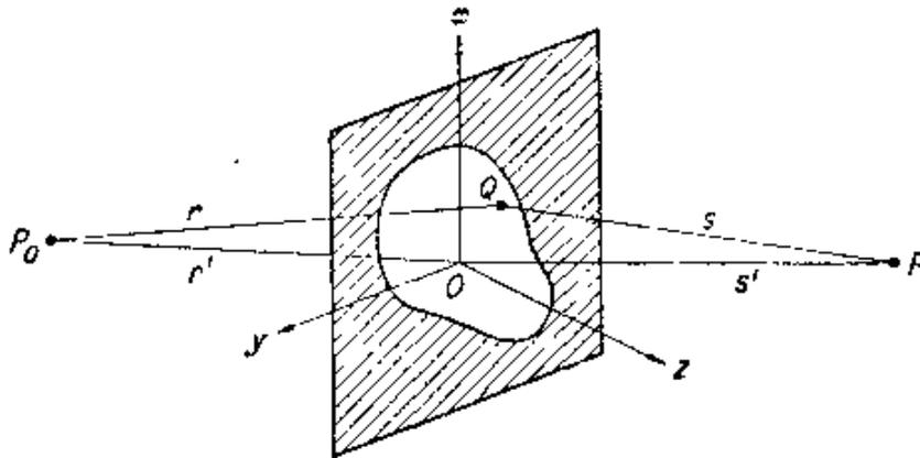
图 8.5 平面屏开孔上的衍射
