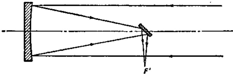
图 6.18 牛顿望远镜
