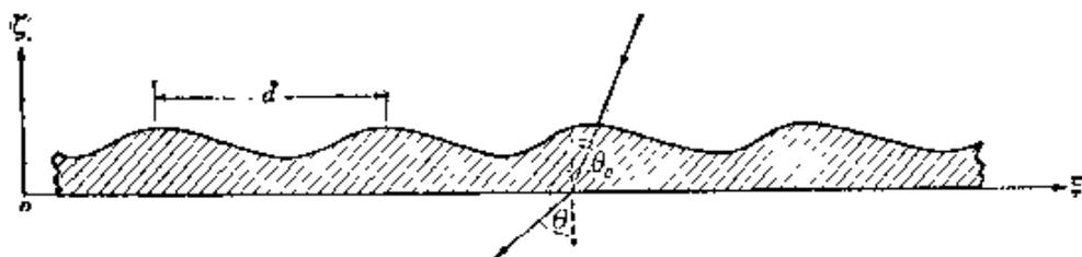
图 8.17 衍射光栅理论图示
