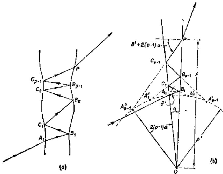
图 7.75 光线沿劈形膜多次反射时位移图示
