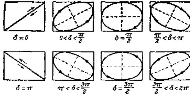
图 1.7 位相差  $\delta$  取不同值时的椭圆偏振
