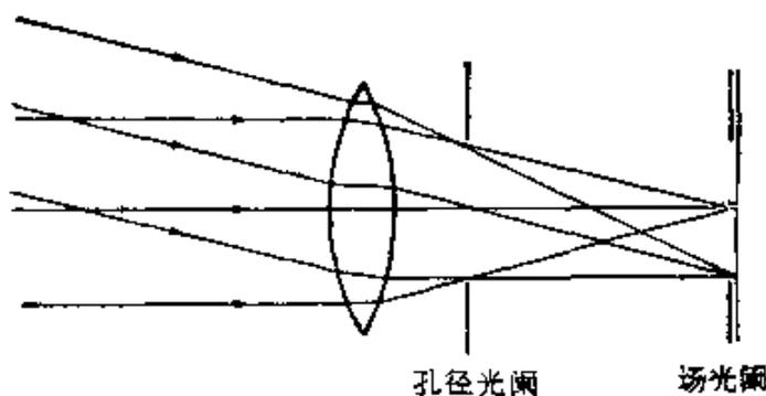
图 4.34 孔径光阑和场光阑二者区别的图示
