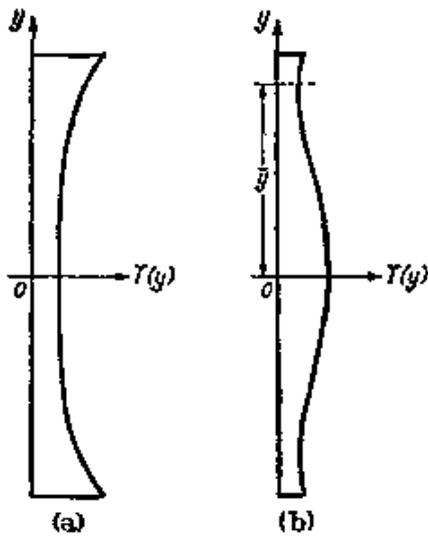
图 6.21 施密特校正板的断面图
