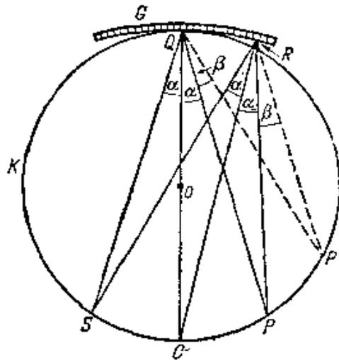
图 8.26 凹面光栅的聚焦作用 (罗兰圆)
