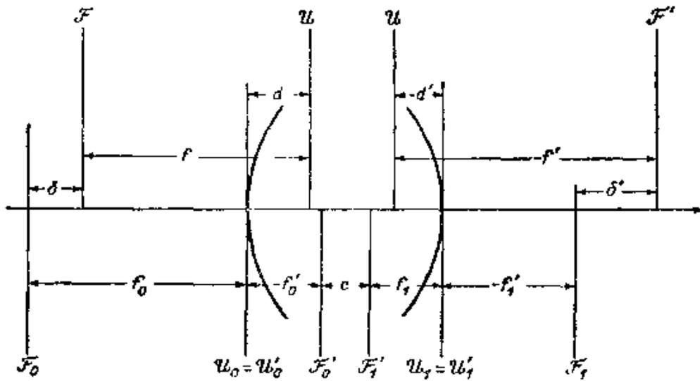
图 4.14 一个组合系统(厚透镜)的基点
