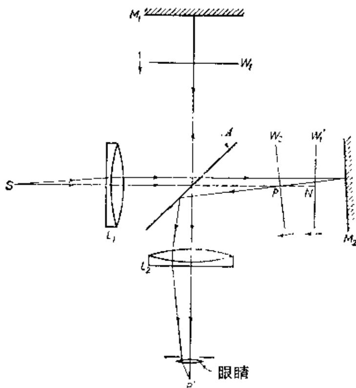
图 7.40 用准直光照明的迈克耳孙干涉仪
