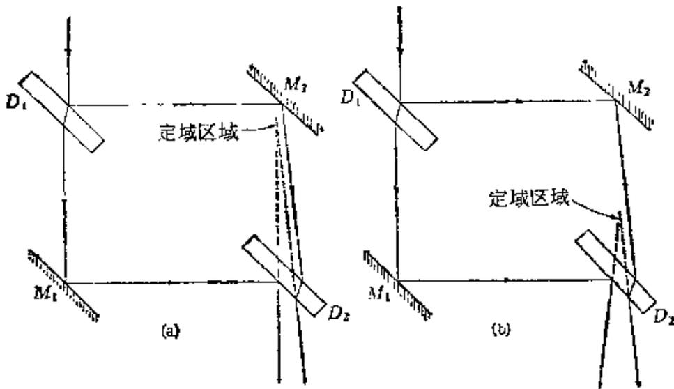
图 7.51 马赫-泽德干涉仪中的条纹定域图示
