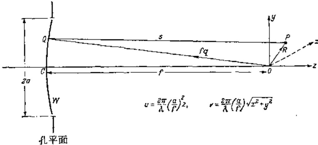
图 8.40 会聚球面波在圆孔上的衍射：符号
