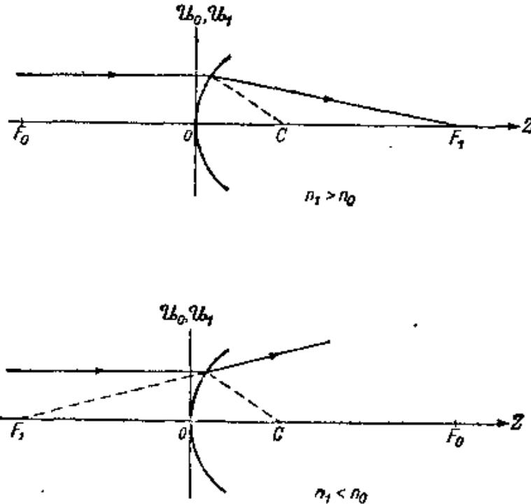
图 4.12 在一个旋转面上折射时基点的位置
