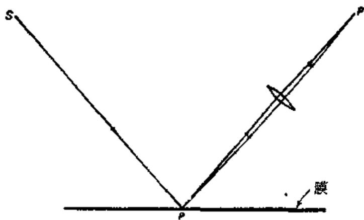
图 7.25 薄膜: 定域在薄膜上的条纹形成图示
