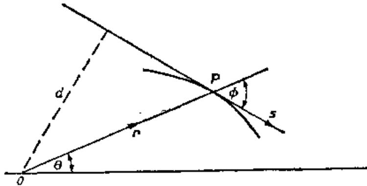
图 3.5 球面对称媒质中光线的博格公式  $nd = \text{常数}$  图示.
