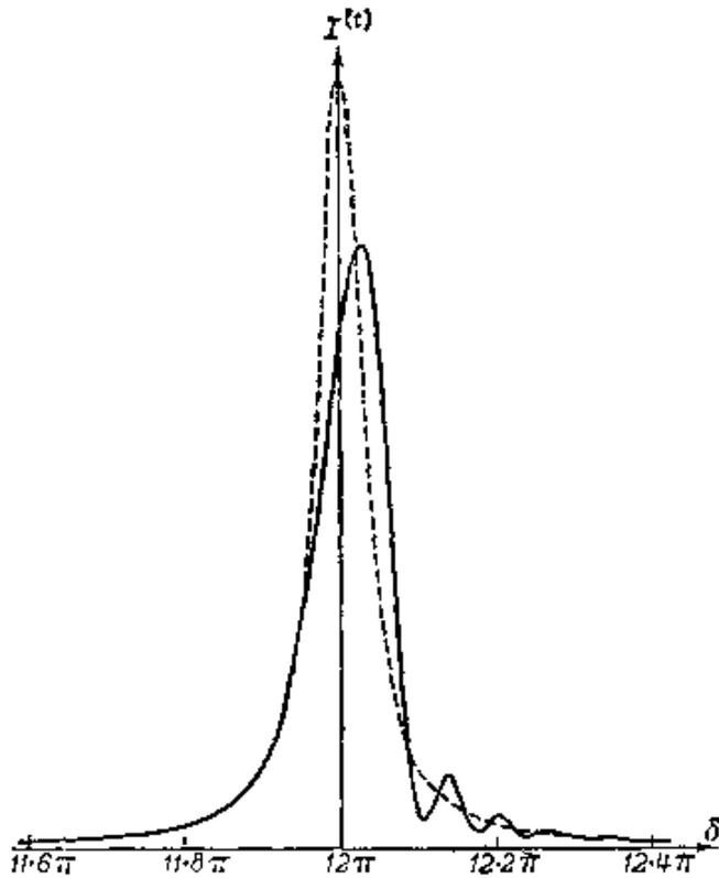
图 7.74 多光束斐索条纹强度分布(实线),
