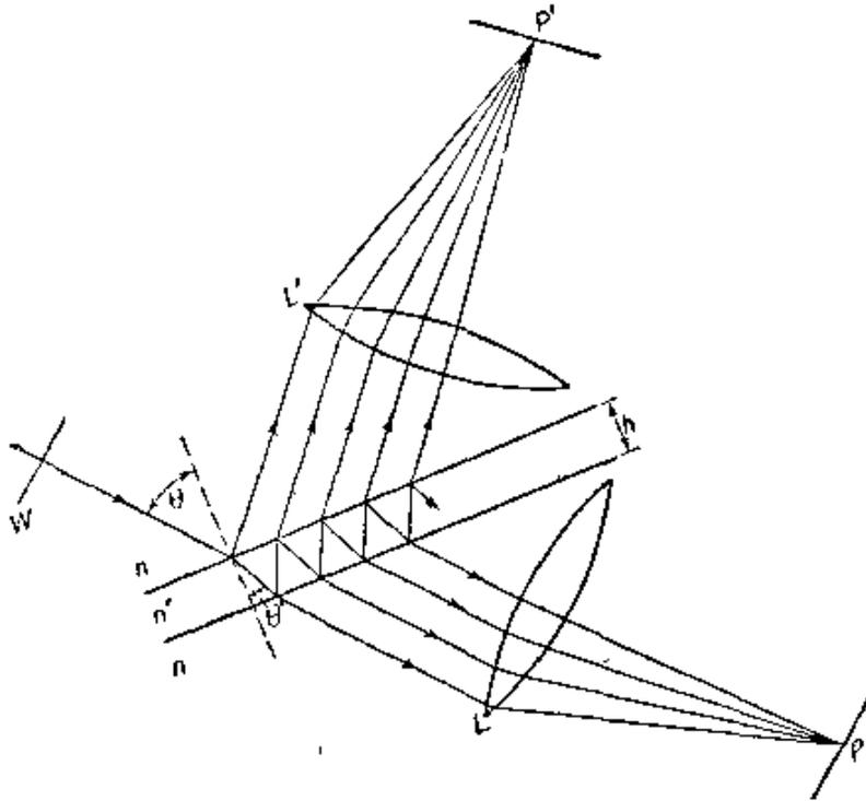
图7.57 平行平板多光束等倾条纹形成图示
