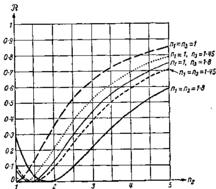
图 1.19  $1/4$  波长膜 ( $n_2 h = \lambda_0/4$ ) 的正入射反射率随膜折射率  $n_2$  的变化关系
