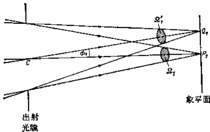
图 4.36 轴外象点上的照度
