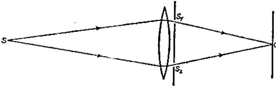
图 7.12 在杨氏装置中使用一个透镜的图示
