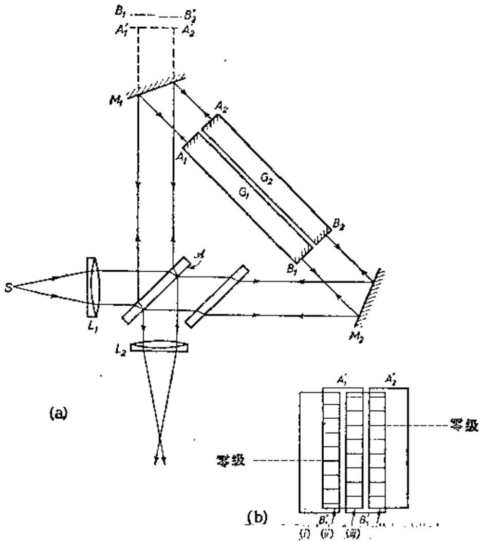
图 7.44 多尔端规干涉仪
