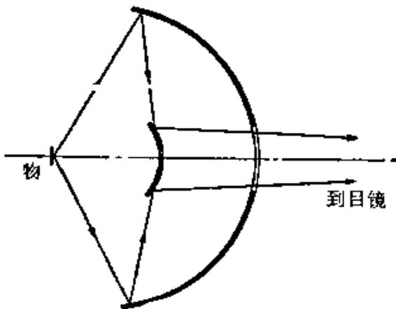
图 6.30 伯奇反射显微镜物镜
