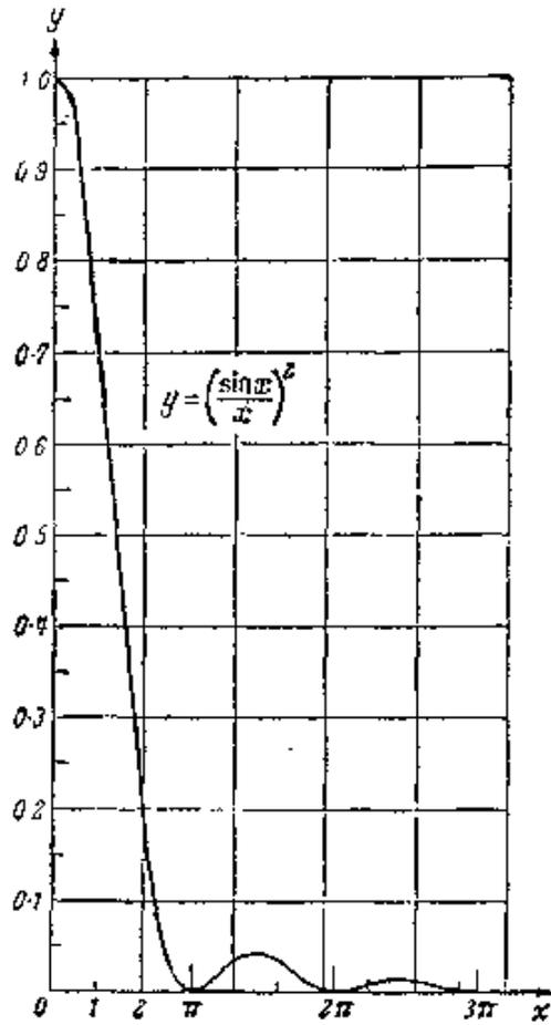
图 8.9 矩孔夫琅和费衍射函数  $y = \left(\frac{\sin x}{x}\right)^2$
