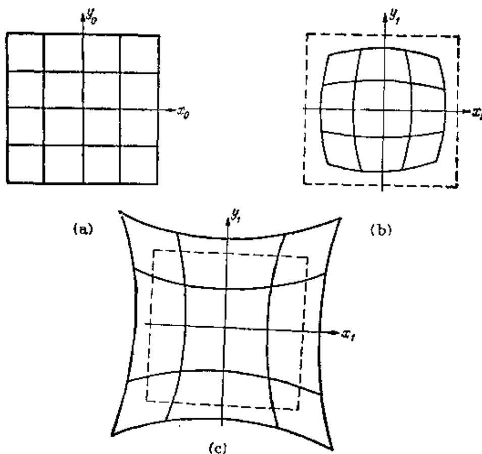
图 5.8 (a) 物 (b) 桶形畸变的象 ( $E > 0$ )
