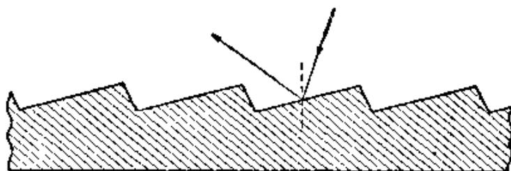
图 8.21 线槽形状特定的反射光栅
