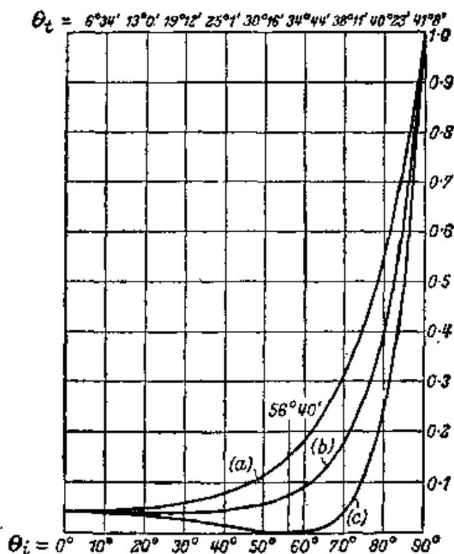
图 1.12 反射光强度随入射角的变化关系
