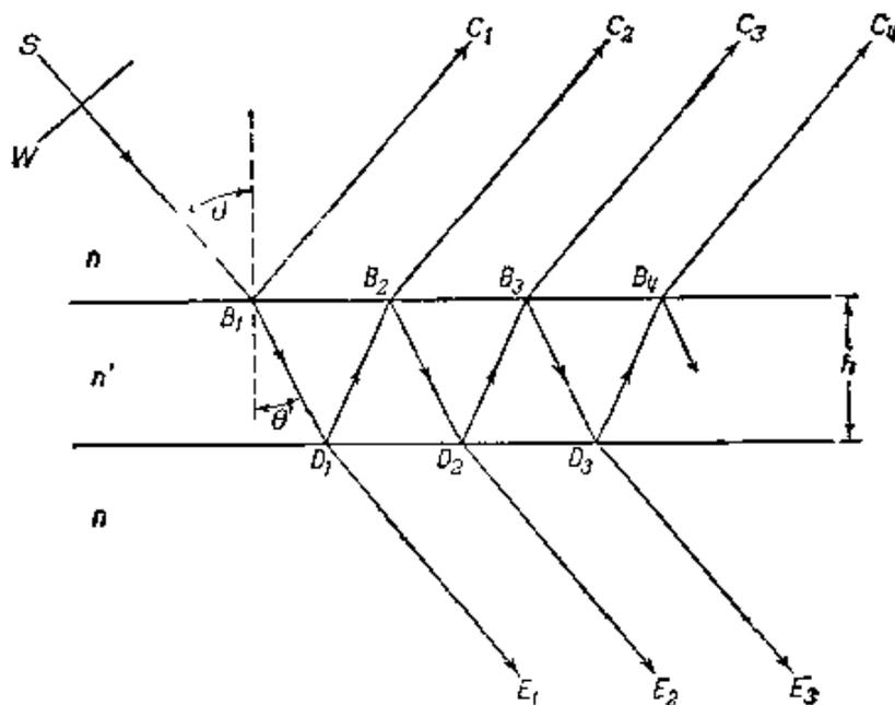
图 7.56 平面波在平行平面板中的反射
