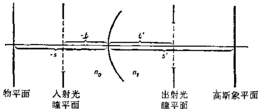
图 5.9 初级象差系数的计算中所用的符号
