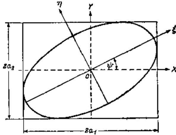
图 1.6 椭圆偏振波 电矢量振动椭圆
