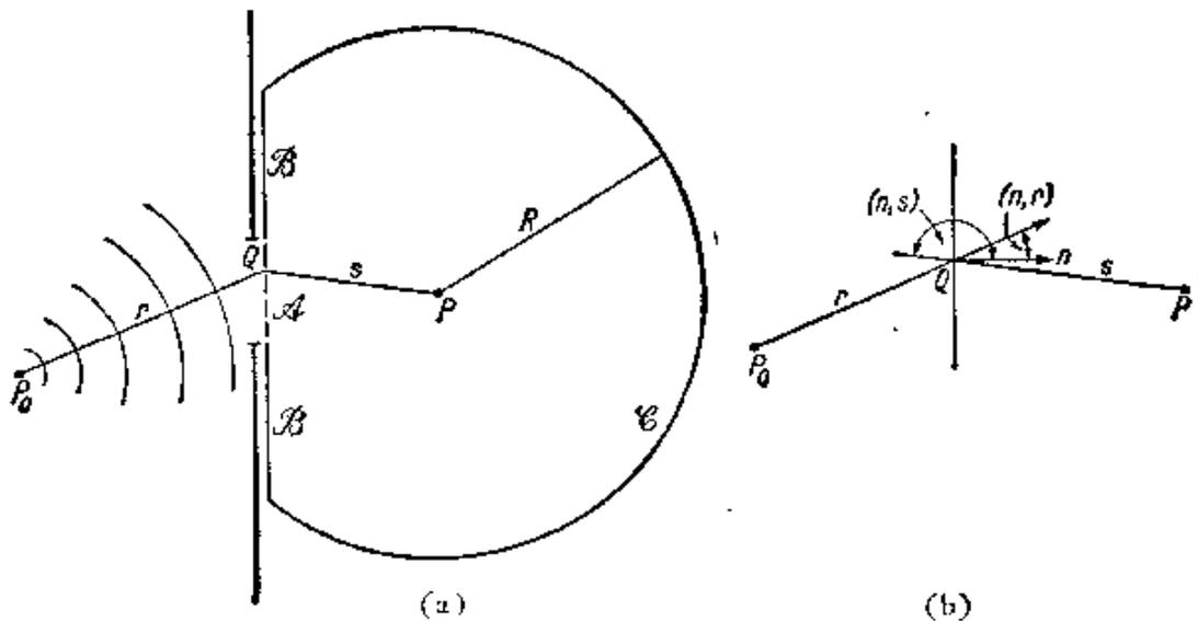
图 8.3 菲涅耳-基尔霍夫衍射公式推导图示
