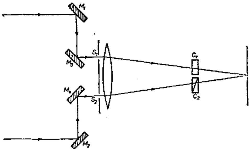
图 7.16 迈克耳孙测量干涉仪
