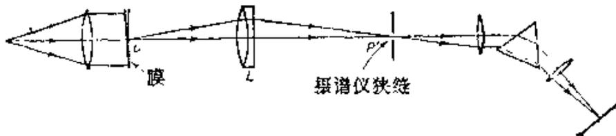
图 7.78 薄膜形成白光条纹的观测装置
