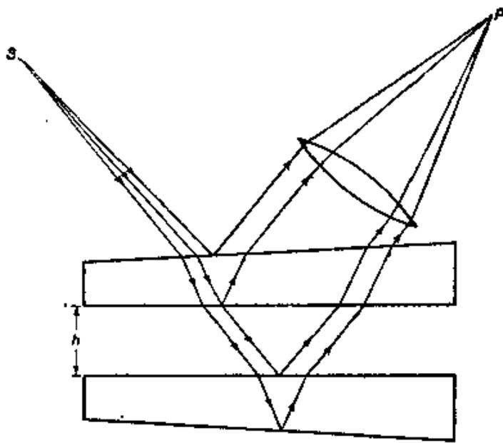
图 7.22 用平行平面空气层产生无穷远定域条纹的图示
