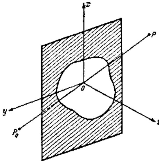
图 8.36 不透明平面屏上开孔的非涅耳衍射
