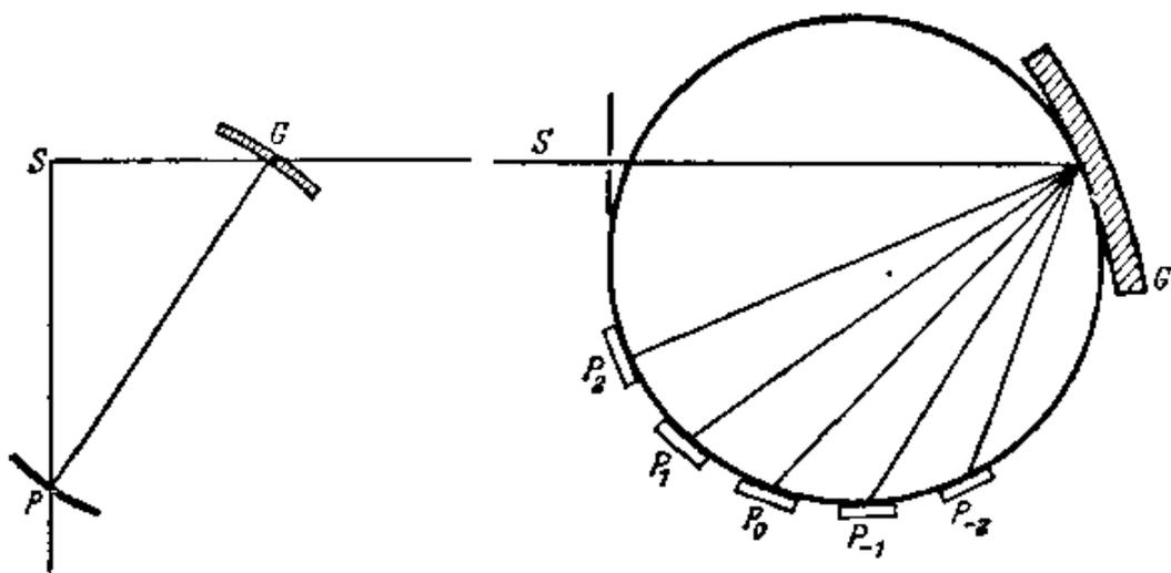
图 8.27 凹面光栅的罗兰装置
