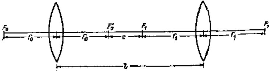
图 4.16 两个共轴薄透镜组成的系统
