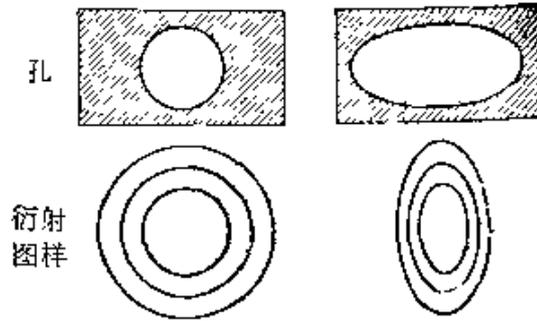
图 8.14 圆孔和椭圆孔夫琅和费衍射的比较
