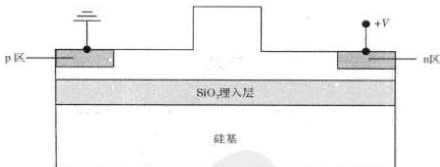
图 10.9 SOI 脊形波导的截面
