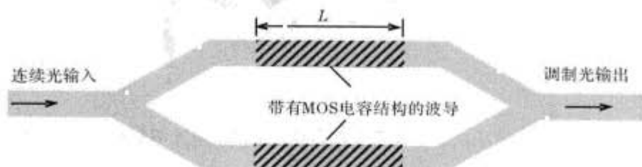
图 10.12 基于马赫-曾德尔干涉仪结构的电光调制器
