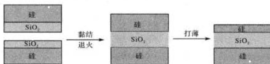
图 4.18 BESOI 工艺基本步骤
