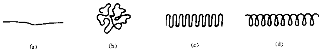
图 30 聚合物二次结构——高分子链构象 (a) 伸直; (b) 卷曲; (c) 折叠; (d) 螺旋
